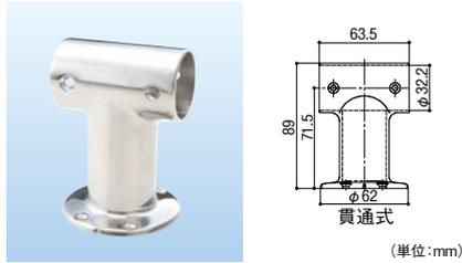
※内部で手すり棒をつきあわせてジョイントプレートとしても使用できます。 ※手すり棒には取付け用下穴(φ2.8mm)をあけてください。
